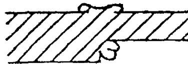
Slika 6 - Loš zavareni spoj sa različitom debljinom zavarenih delova
